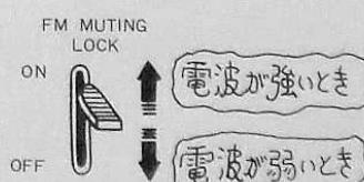
※電波が弱く、雑音が多いときはモードスイッチ〔FM MODE〕をMONOの位置にするか、またはノイズフィルタースイッチをONの位置にしてお聞きください。MONOの位置ではノイズフィルタースイッチをONにしても効きません。
